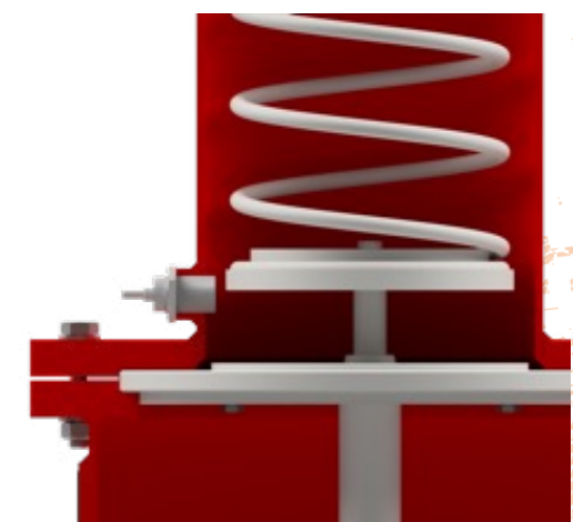
Abb. 4: Schnittzeichnung des Federaufsatzes eines Über- oder Unterdruckrohrleitungsventils mit Näherungsschalter
